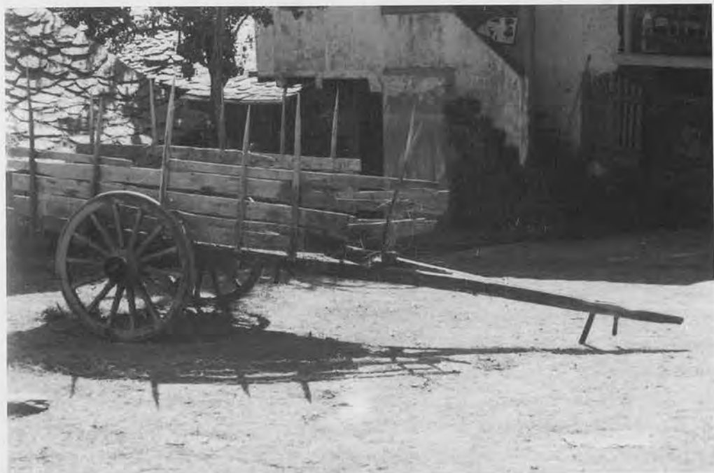
Carro con rodas de raios, aínda en uso (Sortes). Os adrais son de táboas. (Foto 59).
