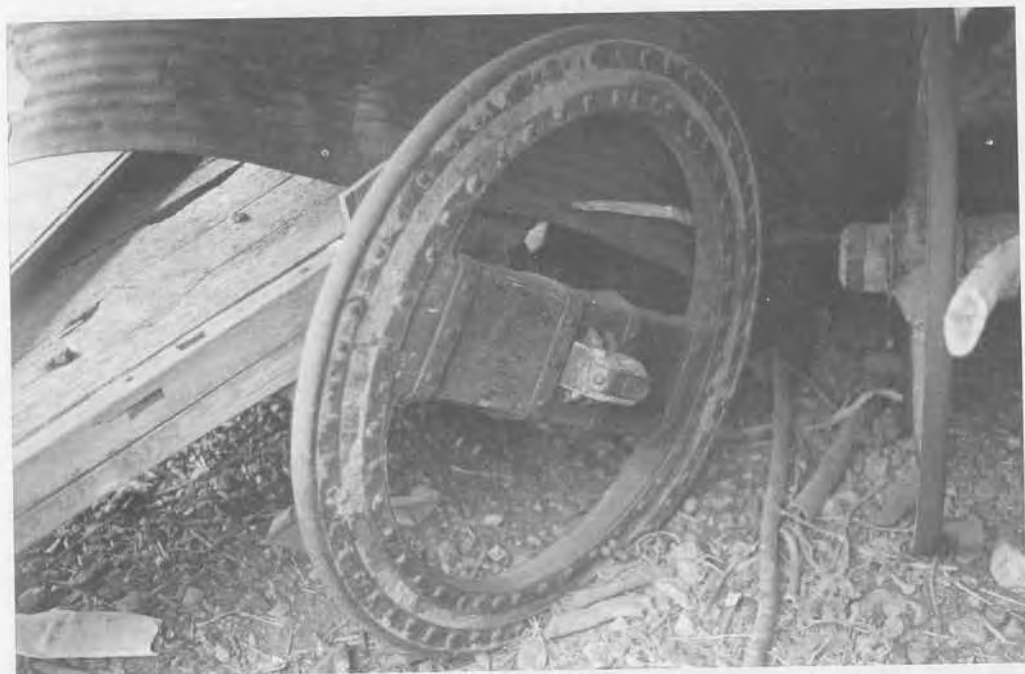
Este tipo de roda, con menos madeira e máis ferro que a tradicional, estivo en uso ata hai poucos anos (Balouta) (Foto 57).
